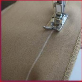
2. Соедините края разреза машинной наметочной строчкой, вынимая булавки по мере приближения к ним иглы.
