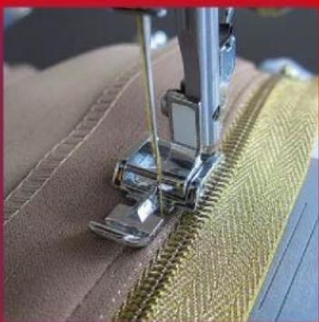
8. Прострочите складку насквозь рядом со сгибом через припуск и тесьму молнии.
